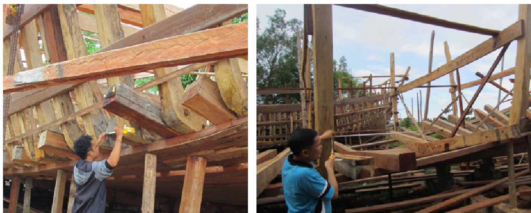
Gambar 1. Pengukuran Gading-Gading Kapal
