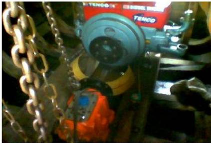
**Gambar 4. Peletakan dan pemasangan mesin pada pondasi mesin**
